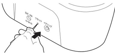
スピーカー（受信機）の動作が不安定な場合などに、リセットボタンを押すことでスピーカー（受信機）の状態をリセットできます。先の細い棒状のものなどでスピーカー（受信機）背面のリセットボタンを押してリセットしてください。リセット後に電源ボタンを押すと、スピーカー（受信機）が再起動します。
